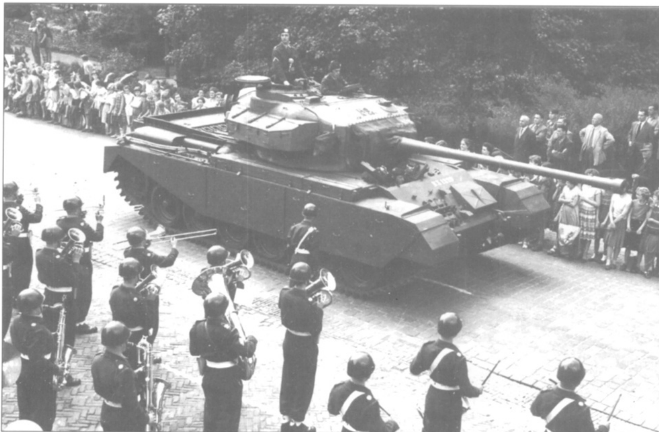
Centurion tank Mk 5 met 20 ponder kanon type A
