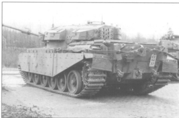
Centurion Mk 7 met 20 ponder kanon type B (met gasafzuiger, zonder mondingsrem)
