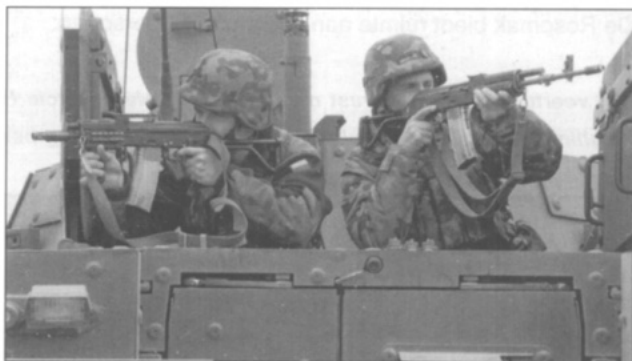
De inzittenden kunnen vanuit het gevechtscompartiment aan het gevecht deelnemen. De opstaande dakluiken bieden extra bescherming.
