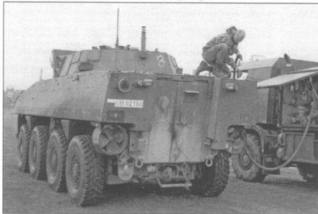
De beide brandstoftanks (164 liter elk) zitten aan de achterkant, aan weerszijde van de deuren. Hier worden ze na een oefening bijgevuld vanuit een 6x6 Jelcz 662D.43 brandstoftankwagen.
